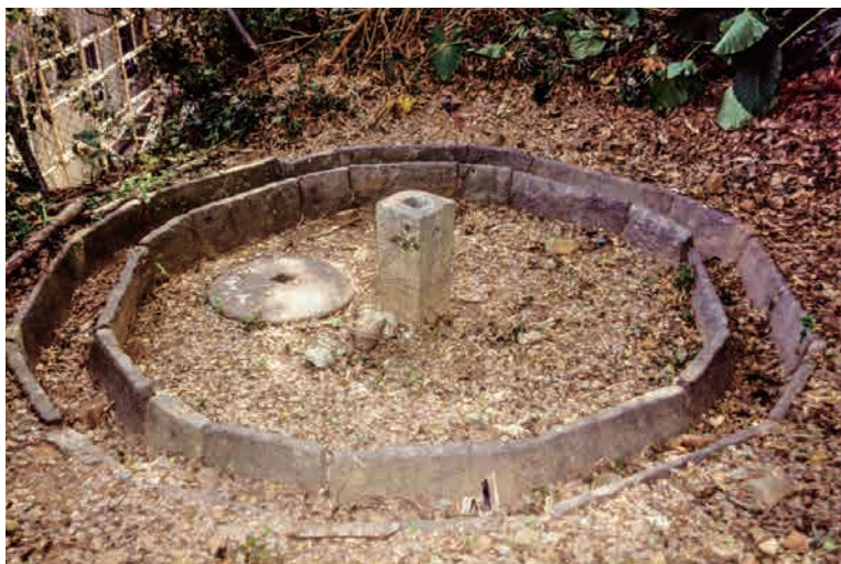
圖 019 上碗窯村的牛碾遺跡，由花崗石製成的碾槽及碾砵組成，是用以將瓷石碾成粉末的工具。(古蹟辦提供)
