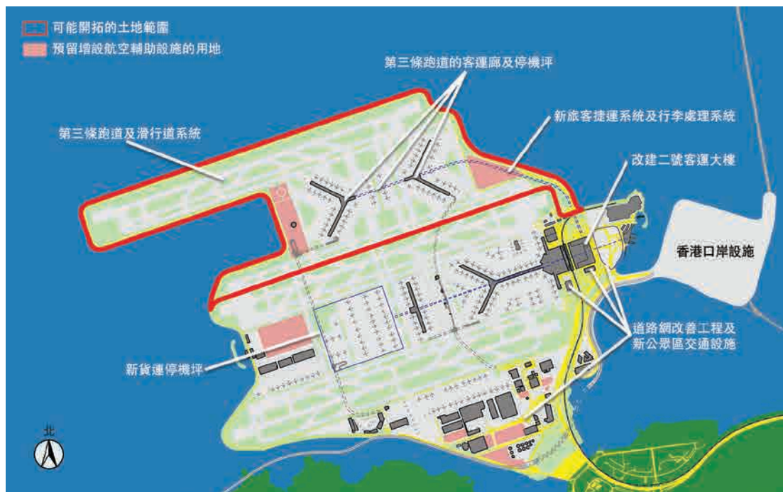
圖 351 2012年3月20日，行政長官會同行政會議決定批准機管局建議，採納「三跑道方案」，包括建設一條全長3800米的三跑跑道及滑行道系統、面積逾28萬平方米的新客運大樓、57個停機位以及停機坪，以及進行二號客運大樓的擴建工程。（香港地方志中心繪製）
